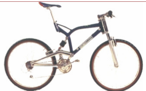
Abb. links zeigt den Prototypen des Antriebschwingsystems von 1994 und gem. Abb. rechts die Verwandlung in ein vollgefedertes Mountainbike. Das Modell „Durango“ ist zu dieser Zeit und auch Jahre später eines der leichtesten (unter 10 kg !) und alltagstauglichen „Fullys“ am Markt, dessen Evolution sich bis in das Jahr 2000 fortsetzt.
