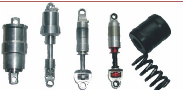
PU-Feder mit Friktionsdämpfung | Erste öl-hydraulische Dämpfereinheit | Verfeinerung der öl-Hydraulik | Serie „Morphos“ mit Elastomer-, Stahl- oder Titanfeder | Der erste german:A. ® Hinterbaudämpfer für Mountainbikes: Die aufgeführten Prototypen von links nach rechts zeigen die Evolution der „Morphos“-Serie von 1994 bis 1996.
